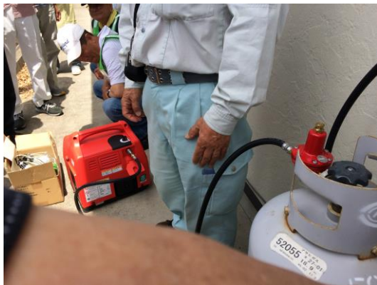
←プロパンガスを使った非常用発電機
